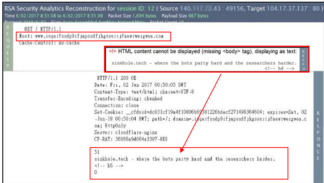
圖 13: 受測主機連到 Kill-Switch 網址的封包解析內容
